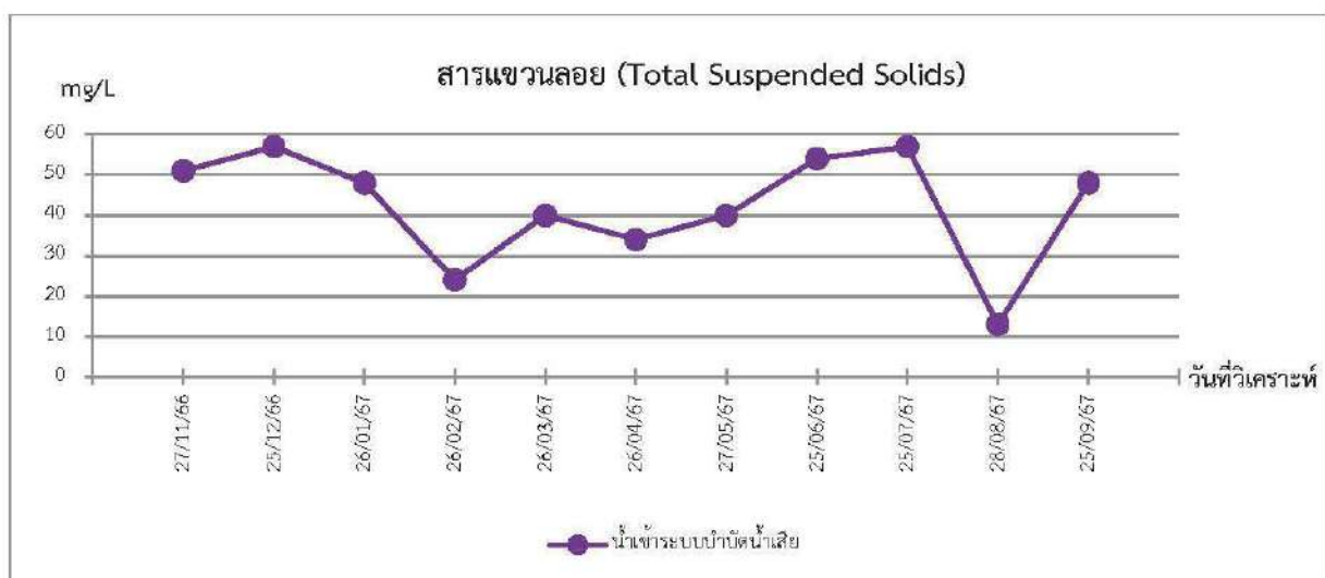
ภาพที่ 3.5.3-2 กราฟเปรียบเทียบผลการตรวจวิเคราะห์คุณภาพน้ำทิ้งก่อนจากระบบบำบัดน้ำเสียในปี พ.ศ. 2566 ถึง ปี พ.ศ. 2567
