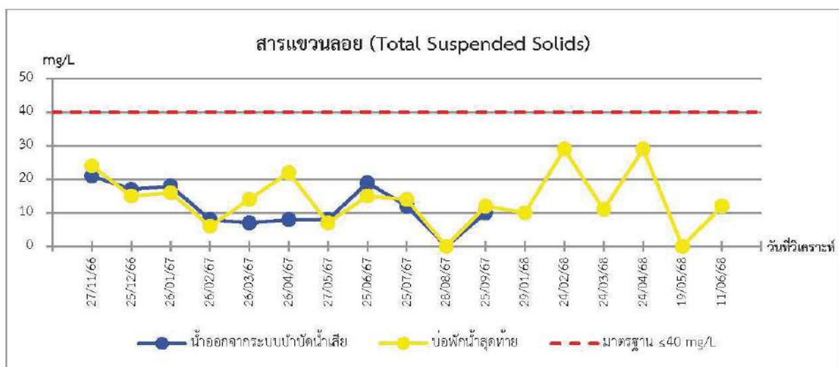
ภาพที่ 3.5.3-3 กราฟเปรียบเทียบผลการตรวจวิเคราะห์คุณภาพน้ำทั้งออกจากระบบบำบัดน้ำเสีย และบ่อกักน้ำสุดท้าย ก่อนระบายออกโครงการในปี พ.ศ. 2566 ถึงปัจจุบัน
